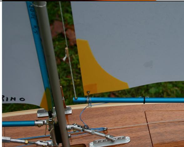
**AMANTIGLIO** : la punta interna del boma del fiocco deve essere collegato con una scottina regolabile con un "biscotto" per poter regolare facilmente il fiocco stesso.
