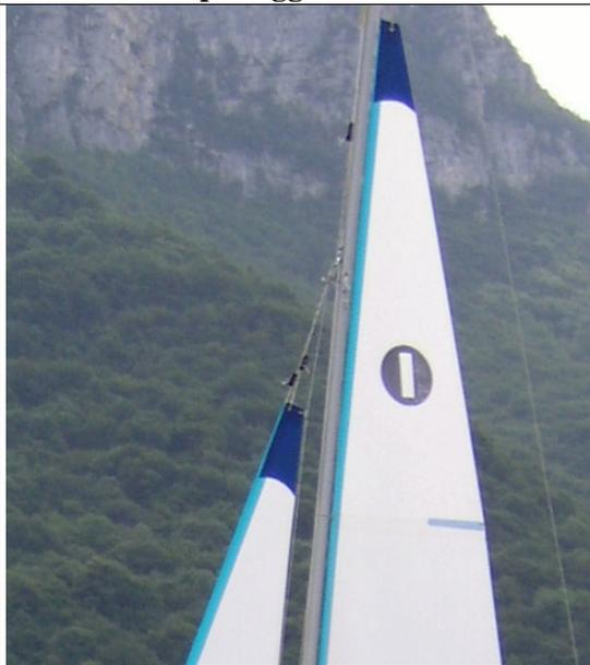
**ATTACCO FIOCCO ALTO :** il filo di acciaio e la scottina che tiene il fiocco nella parte alta (vedere foto) devono essere agganciati all' albero usando i biscottini (si vedono 2 neri nella foto che tengono il fiocco) per la regolazione fine. Vedremo dopo l' amantiglio
